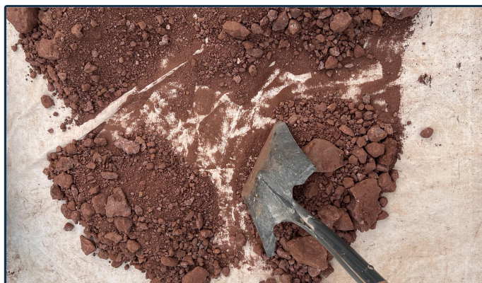
Imagen 5 — Cuarteo de material para la preparación de muestras de laboratorio.
