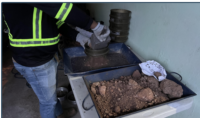
Imagen 6 — Ensayo de granulometría de gravas en laboratorio de control de calidad EDD.
