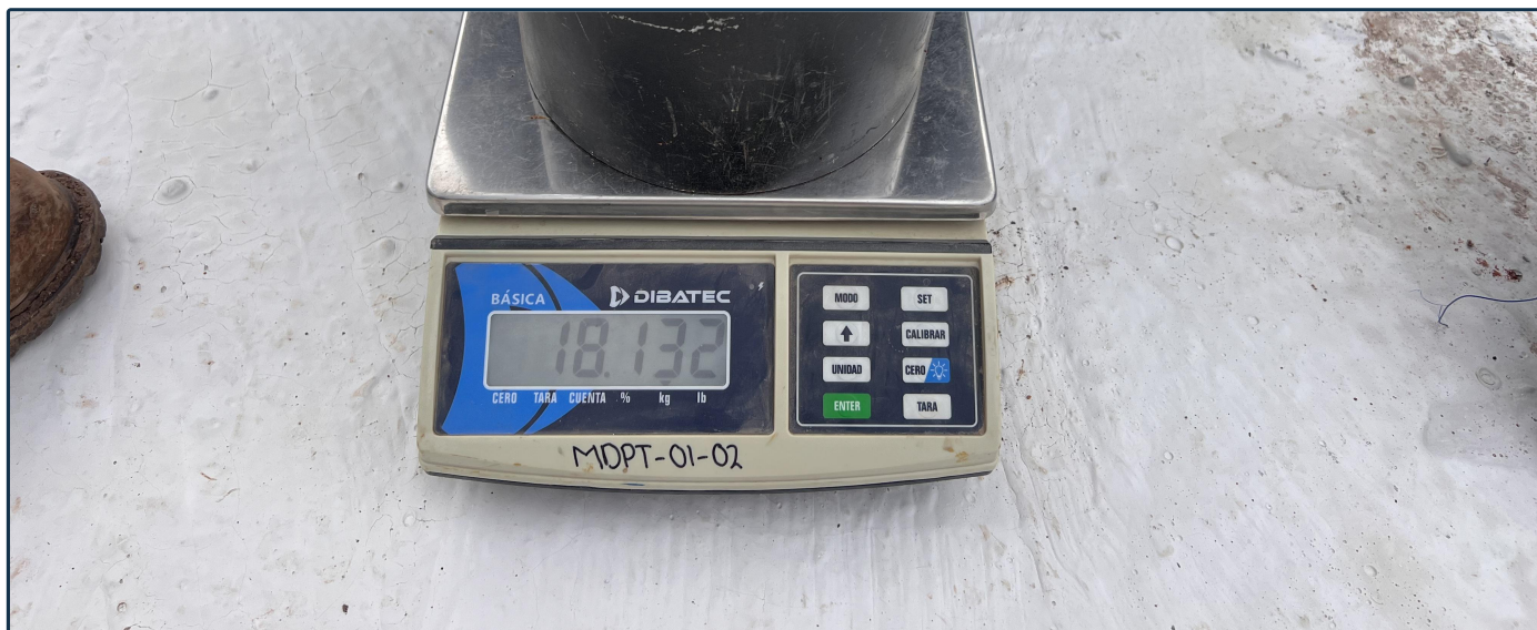
Imagen 4 — Determinación del peso volumétrico seco suelto del material (recipiente MDPT-01-02).
