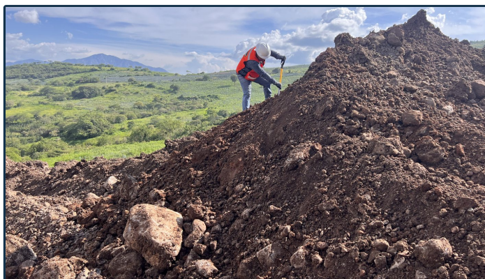
Imagen 5 — Toma de muestra de material sobre el terreno.
