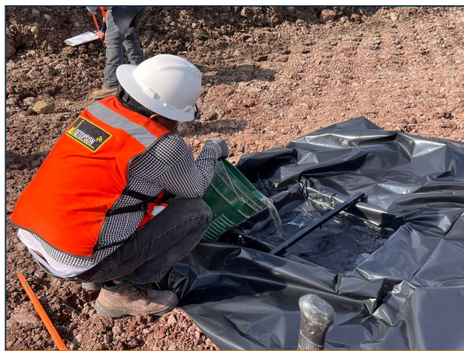
4. Prueba de reemplazo de agua para determinación de la densidad de campo.
