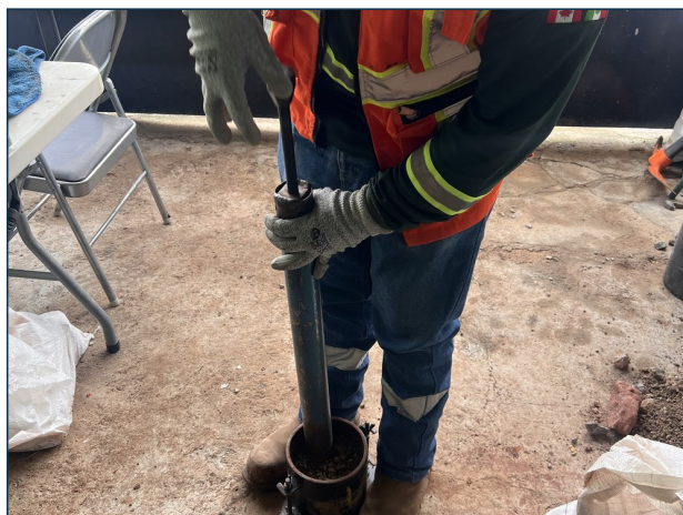
4. Ensaye Proctor — compactación de la muestra en molde.
