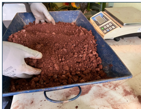
4. Preparación de material para el ensaye Proctor.
