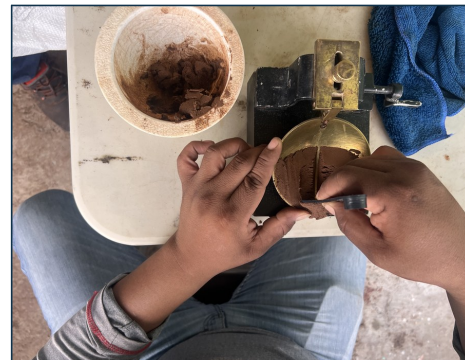
3. Ensayo de límites de consistencia (Atterberg).
