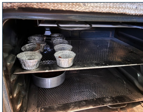
5. Muestras Proctor en horno para determinación de humedad.
