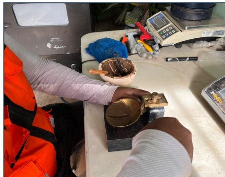
3. Ensayo de límites de consistencia (Atterberg).
