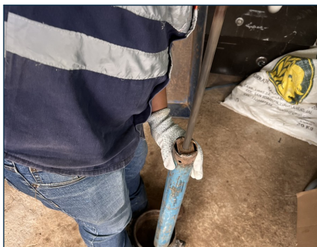
4. Ensayo Proctor — compactación de la muestra.
