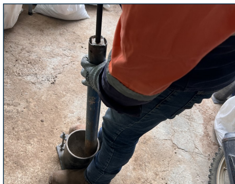
5. Ensayo Proctor — vista del molde.
