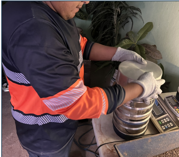
Imagen 2 — Pesaje de fracciones de material, granulometría de arenas.
