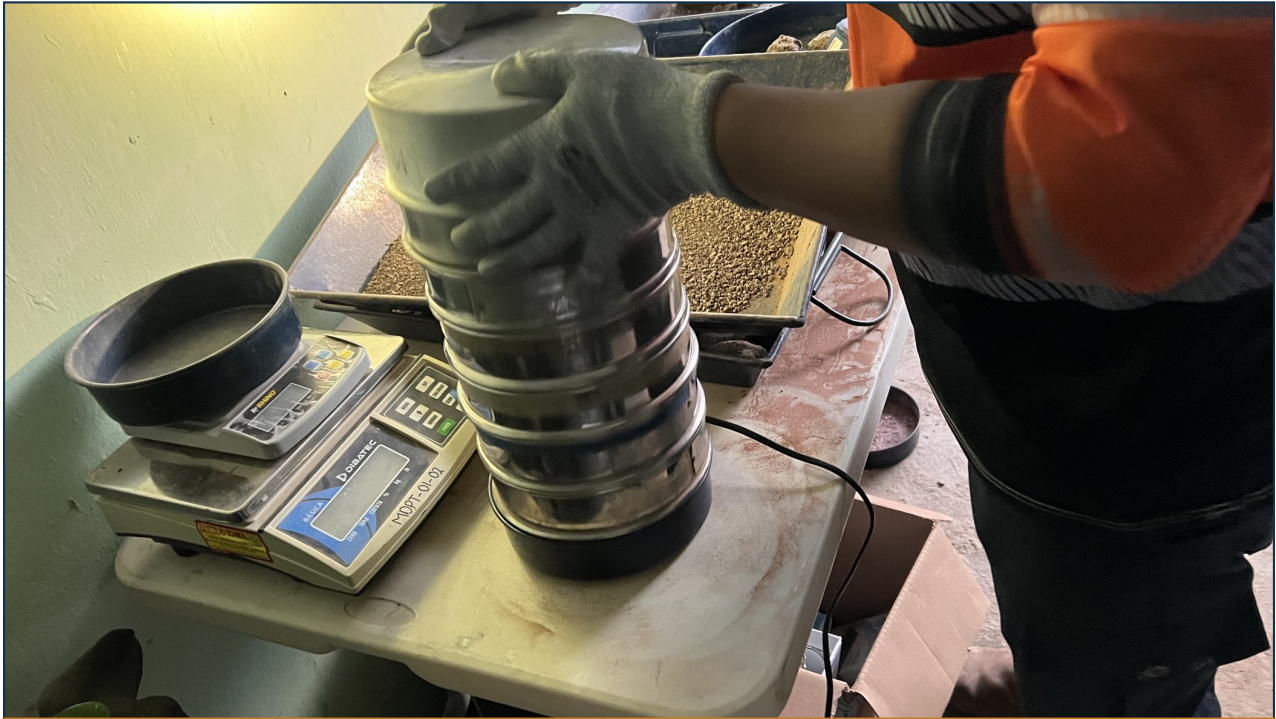
Imagen 1 — Armado de la columna de mallas para el ensaye de granulometría de arenas.
