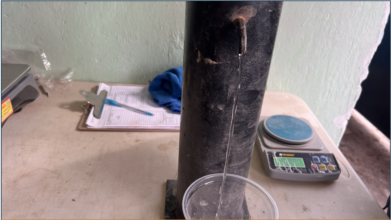
Imagen 4 — Desalojo de agua por el método del picnómetro, ensaye de densidad y absorción de roca.
