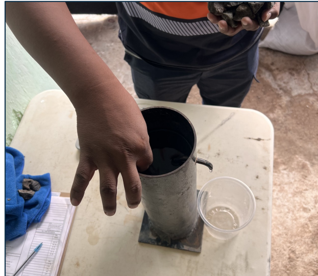
Imagen 3 — Inicio del ensaye de densidad y absorción de roca — toma de muestra.
