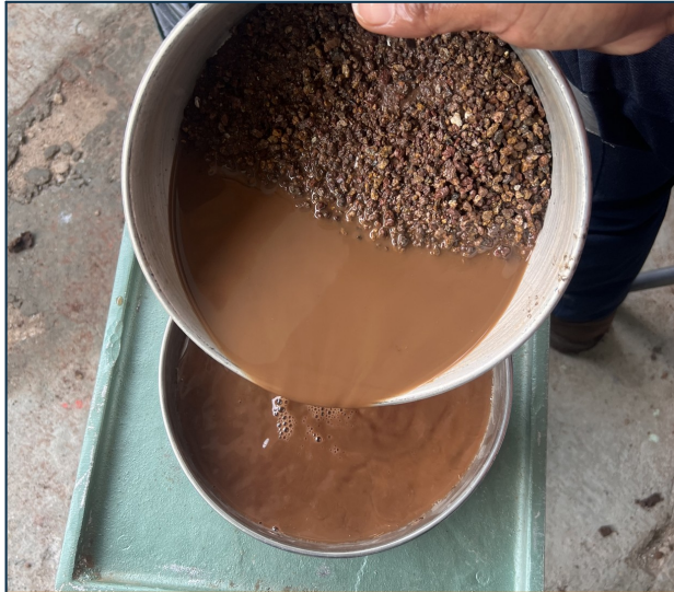
Imagen 5 — Lavado de material, granulometría de arenas.
